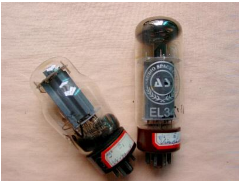
几种在音频放大器里常用的电子管图示四： 两种管型的中功率功率放大管：6550
