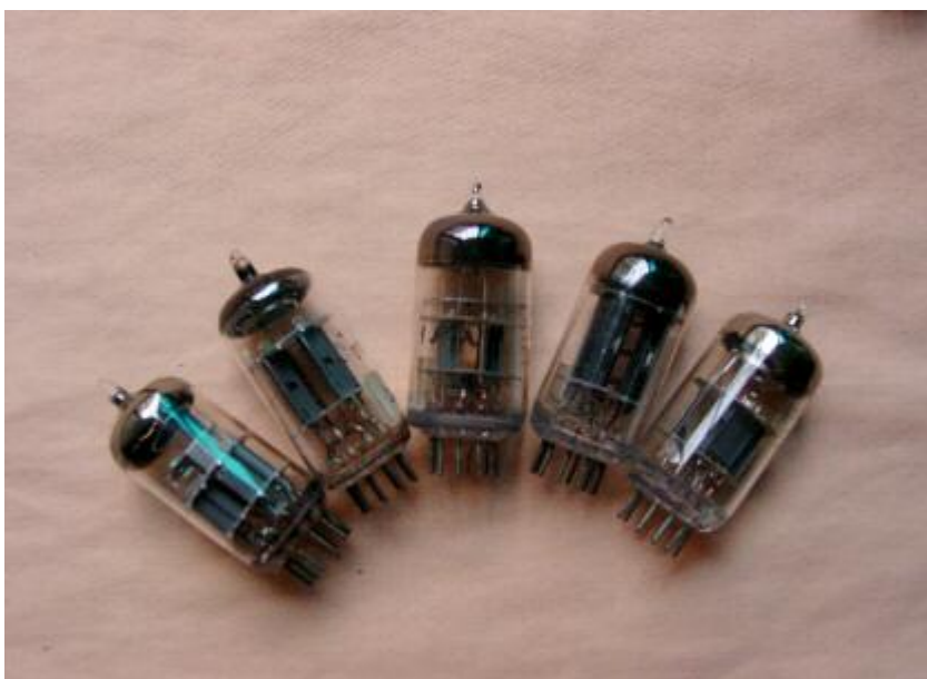
几种在音频放大器里常用的电子管图示七： 五颗前置电压放大管：6N11，6N2，12AU7，6922，6N4
