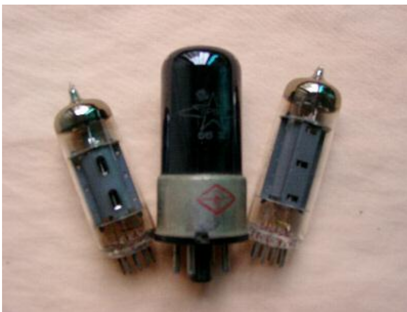
几种在音频放大器里常用的电子管图示三： 三颗中功率功率放大管：6P3P，EL34
